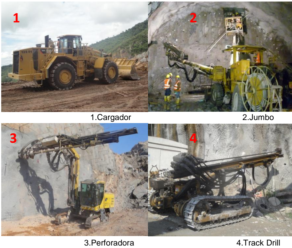
Figura 12. Maquinaria utilizada en las excavaciones, 1° parte
