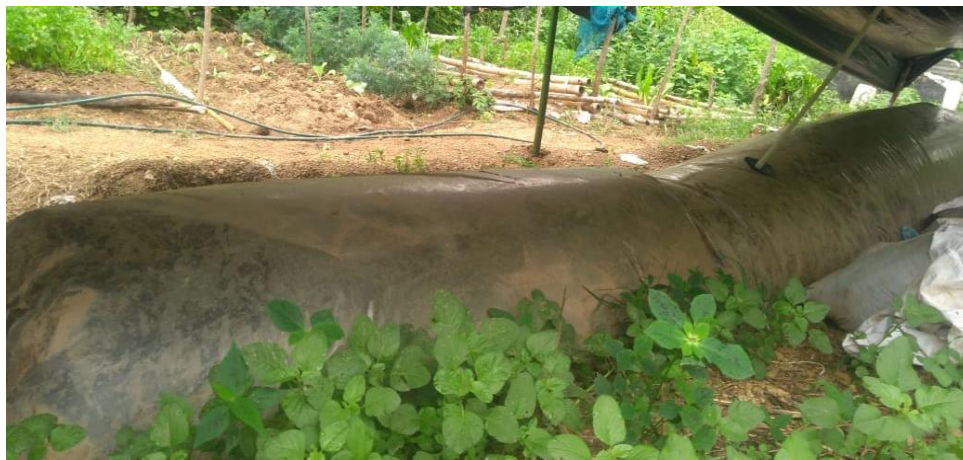
Figura 7. Digestor en el sitio de pruebas.
