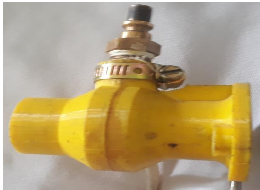
Figura 5. Mezclador de biogás
