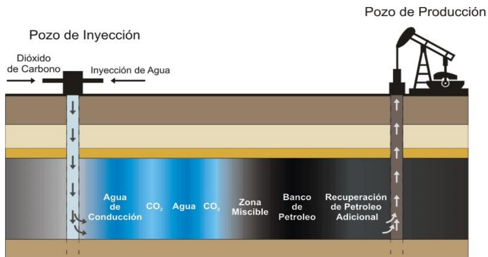
Figura 1. Proceso de recuperación secundaria mediante bombeo mecánico e inyección
