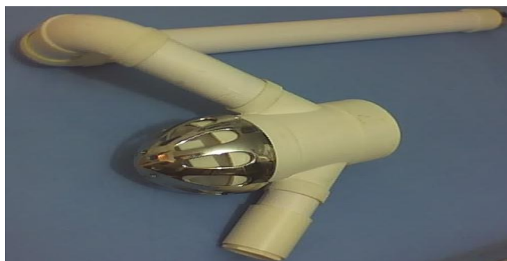
Figura 82. Cono limitador construido
