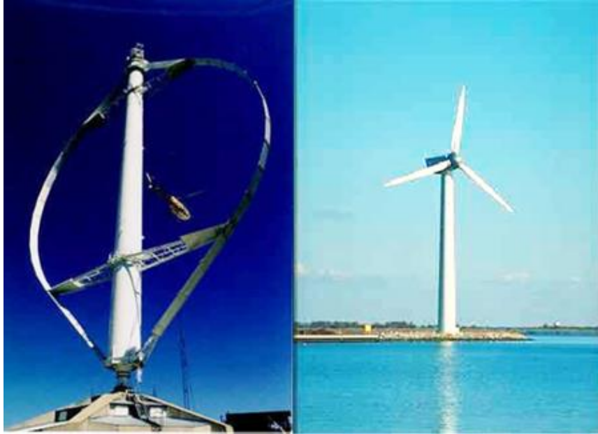
Figura 1: Tipos de turbinas eólicas según su eje de rotación.
