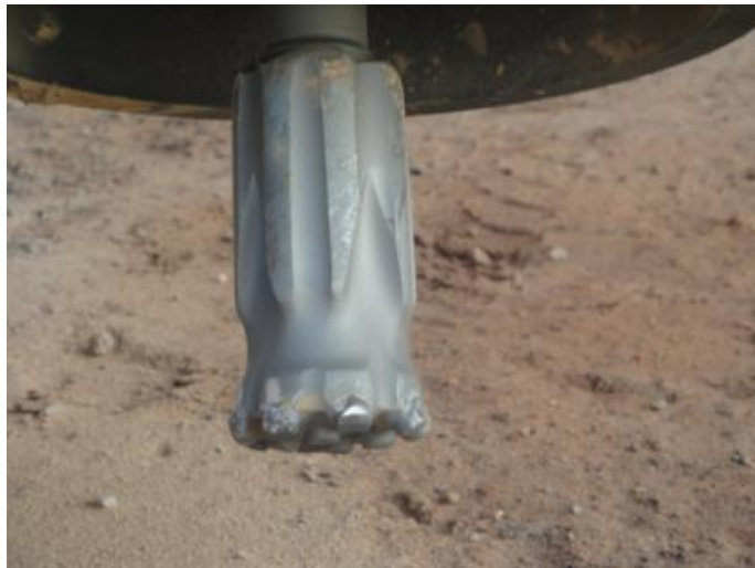
Figura 40. Detalle De La Broca De Tungsteno
