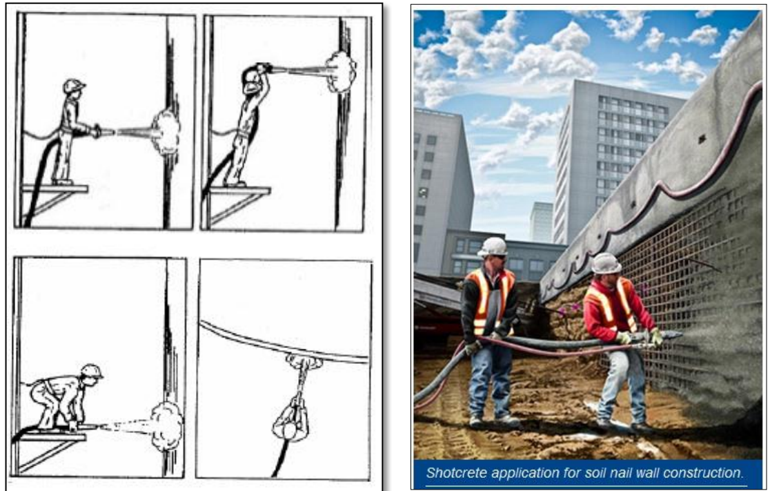
Ilustración 21: . Posiciones correctas para la aplicación del concreto lanzado
