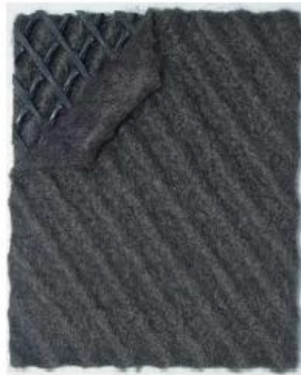
Ilustración 13: Detalles de un geocompuesto
