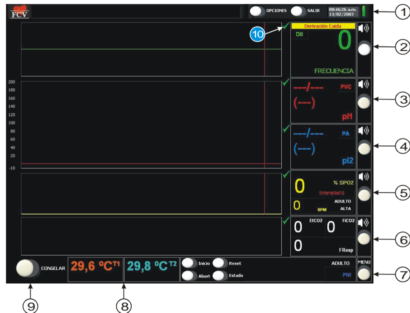
Gráfico 19. Visualización en pantalla de los canales de monitorización del MSV
