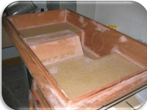
Gráfico 114. Moldes en madera para elaboración de bandejas inferior e intermedia
