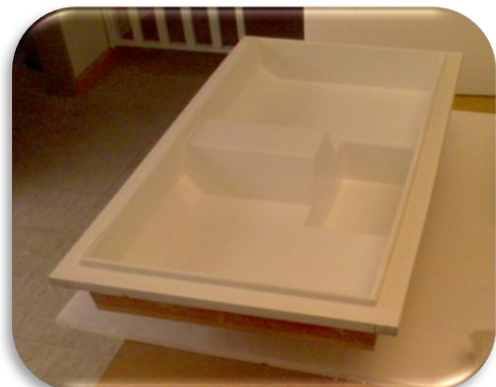
Gráfico 114. Moldes en madera para elaboración de bandejas inferior e intermedia
