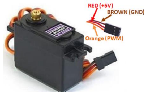
Figura 21. Conexiones servomotor MG996R
