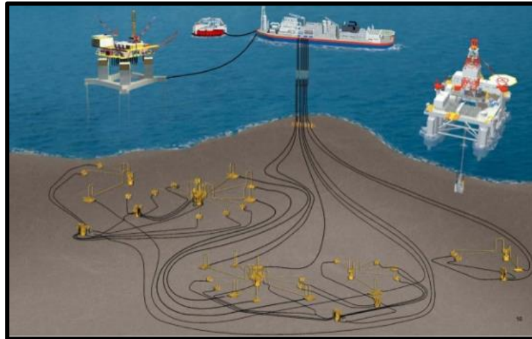
Figura 14. Arquitectura de producción submarina
