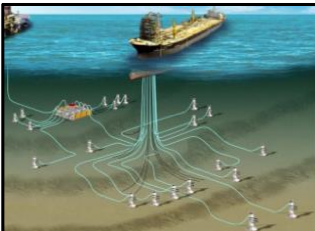
Figura 11. Esquema de funcionamiento de un FPSO anclado al fondo marino en un campo petrolero
