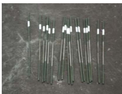
Fotografía 2. Varillas de acero al carbono utilizadas para la preparación de las probetas, delimitando su respectiva área de trabajo con pintura epóxica (Epoxipoliámida de Pintuco)
