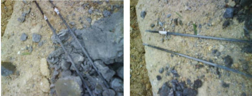
Fotografía 7. Varillas del torón al destruir las probetas.
