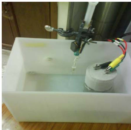
Fotografía 5. Montaje de la probeta en la solución salina.
