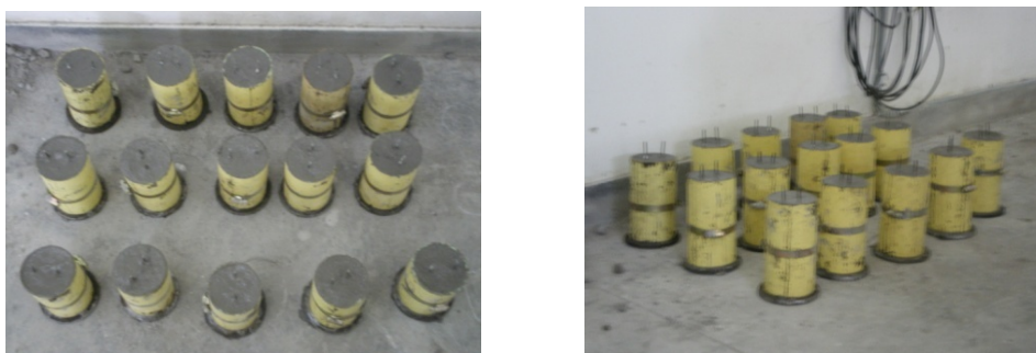
Fotografía 2. Varillas de acero al carbono utilizadas para la preparación de las probetas, delimitando su respectiva área de trabajo con pintura epóxica (Epoxipoliámida de Pintuco)
