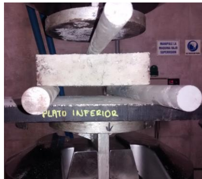
Figura 15. Ensayo a flexión para adoquín mediano
