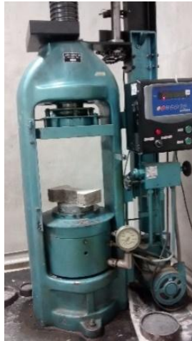
Figura 12. Ensayo a compresión de adoquines
