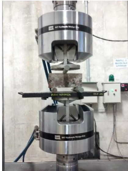
Figura 14. Ensayo a flexión para adoquín grande
