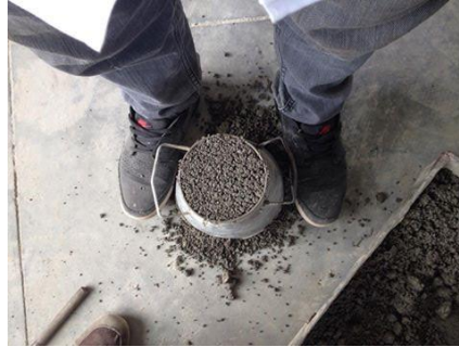
Figura 5. Ensayo de asentamiento del concreto
