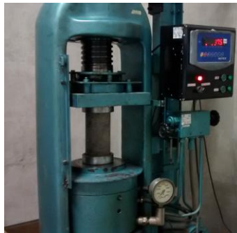
Figura 7. Ensayo de resistencia a compresión
