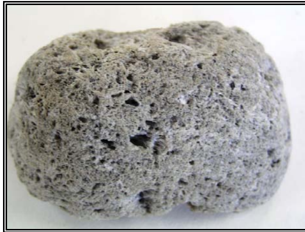
Figura 20. Porosidad total en una roca volcánica
