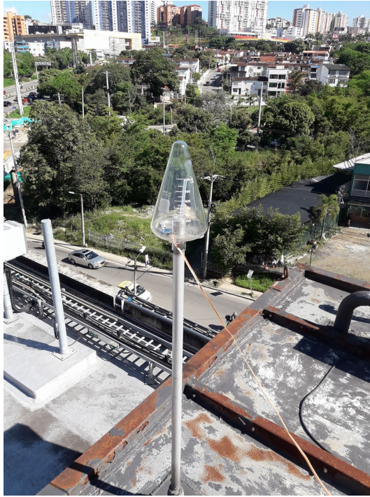
Figura 44: Prueba del sensor MQ131 con generador de ozono
