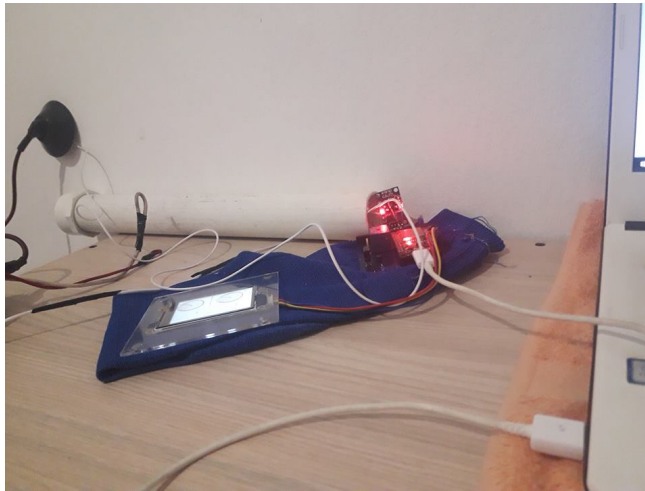
Figura 45: Prueba del sensor MQ131 con generador de ozono
