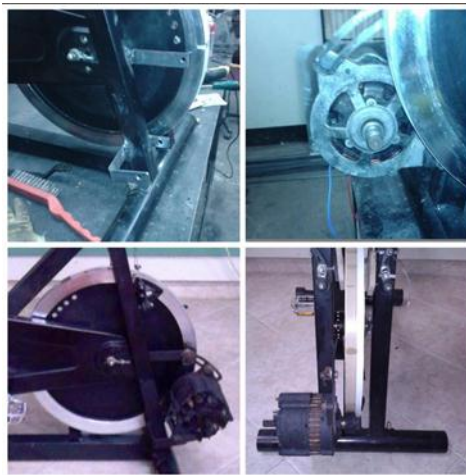
Figura 6. Acople de la bicicleta Spinning y el alternador.
