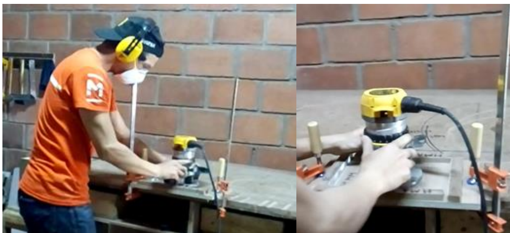
Figura 23. Usuario operando una ruteadora manual DeWalt.
