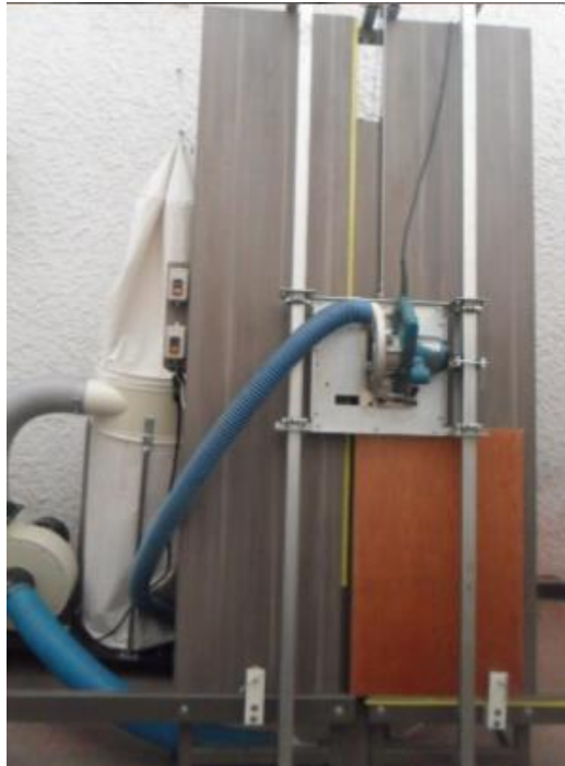
Figura 13. Proyecto de grado UIS, cortadora de láminas de madera. Nota: recuperado de “Diseño y Construcción de una Máquina de Corte para Láminas de Madera”, de Sánchez, C., 2012, Universidad Industrial de Santander, p. 158. Recuperado de http://tangara.uis.edu.co/biblioweb/tesis/2019/174955.pdf
