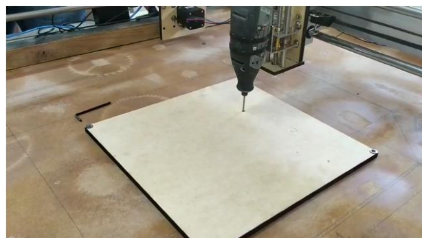
Figura 63. DiRu cortando MDF de 9mm en las pruebas
