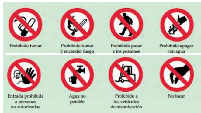
Figura 34. Señales de prohibición.
