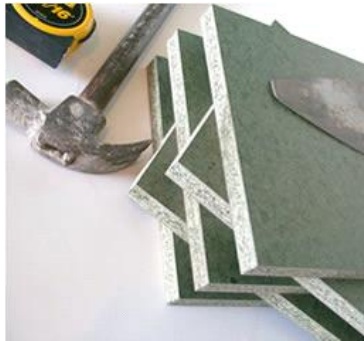
Figura 19. Tipo de madera resistente a la humedad. Formaleta, (S.A. 2013)
