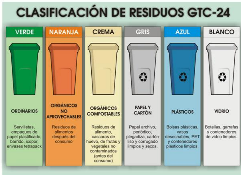
Figura 5. Código de colores para separación de residuos según la norma técnica GTC-24.
