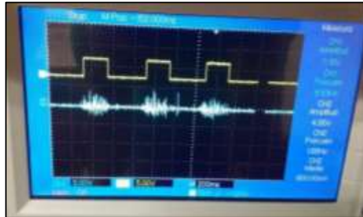
Figura 119. CH1 Pre Amplificador. CH2 Monoestable (con tarjeta PCB)
