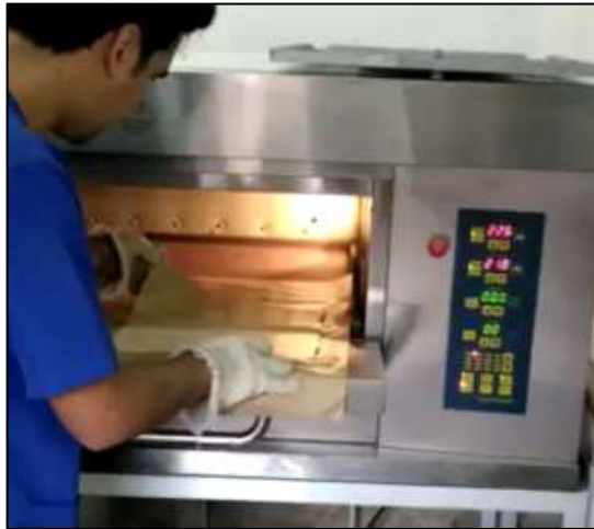
Figura 98. Calentamiento de la lámina de polipropileno.
