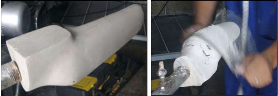
Figura 96. Molde y Termoformado del socket interno.
