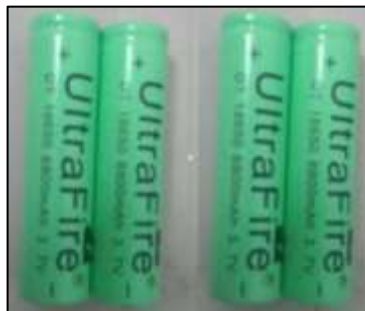
Figura 27. Baterías utilizadas para alimentar todo la instrumentación y sistema electrónico de la prótesis.
