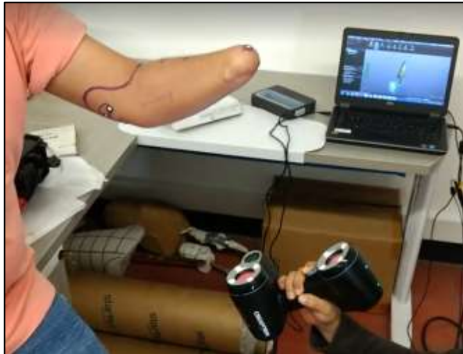
Figura 87. Proceso de escáner 3D, con escáner GoScan Creafom.
