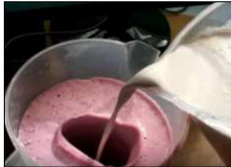
Figura 33. Vertimiento de yeso dentro de la cavidad del molde.
