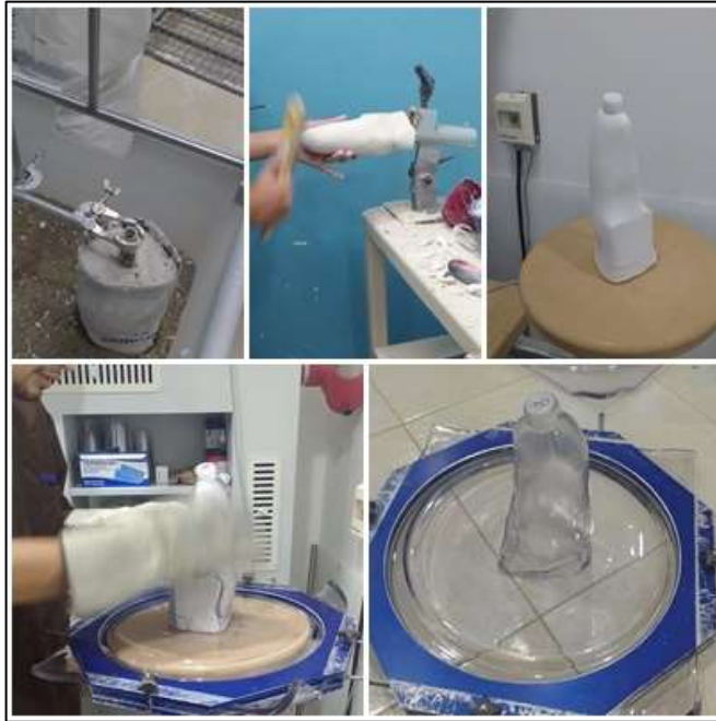
Figura 91. Proceso de plastificado de socket.
