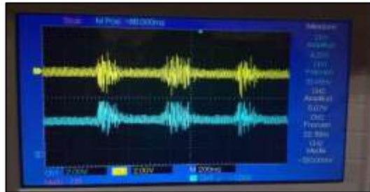
Figura 112. CH1 Pre-Amplificación. CH2 Filtro Pasa Bandas (con tarjeta PCB)
