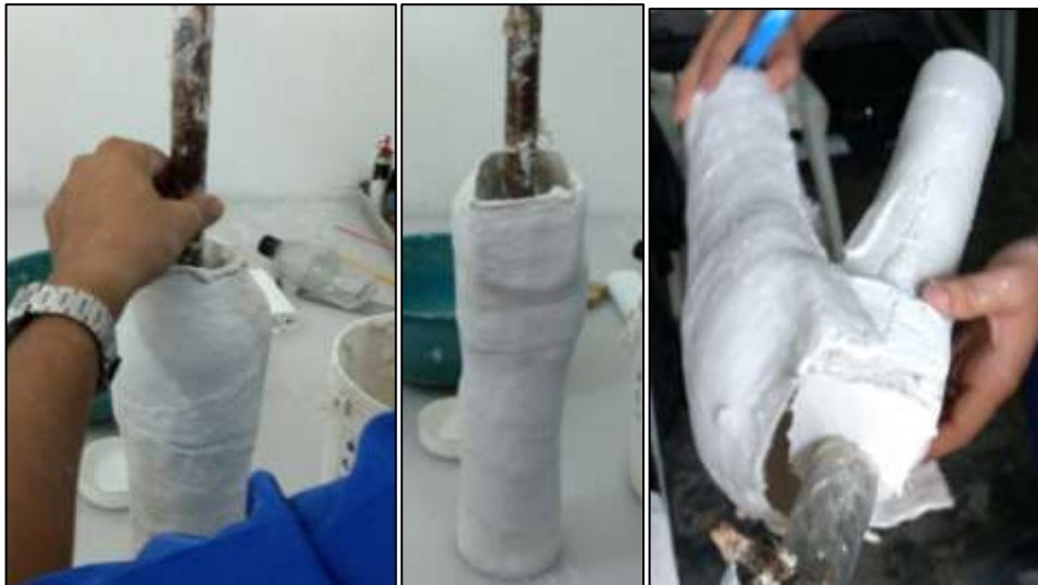
Figura 97. Conformado del molde del socket externo.
