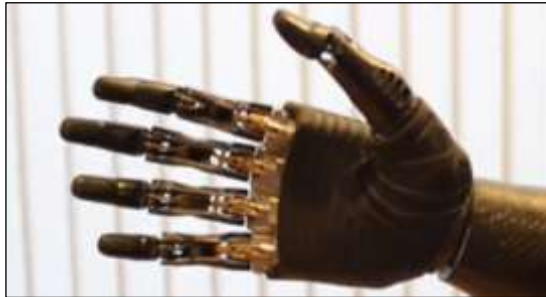
Figura 36. Prótesis mioeléctrica con transmisión por pistones.
