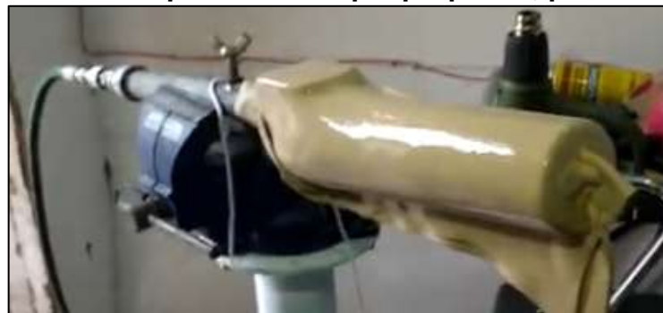
Figura 99. Termoformado por vacío del polipropileno, para el socket externo.
