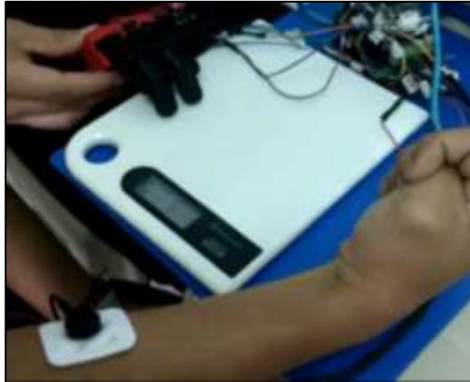
Figura 124. Medición de fuerza de agarre máxima ejecutada por el prototipo.
