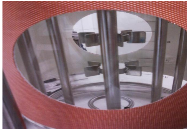
Figura 7. Agitador impeller tipo turbina plana.
