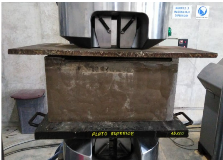
Figura 11: Montaje del ladrillo de PET y arena para hacer prueba de compresión.
