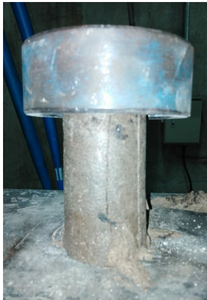
Figura 9: Pruebas de compresión sobre probetas cilíndricas.
