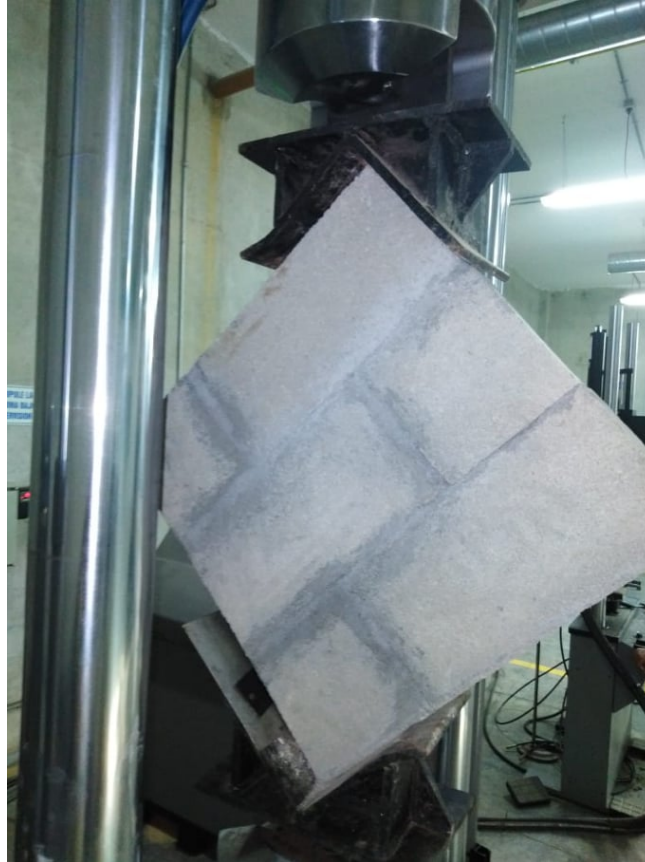
Figura 13: Montaje del muro de ladrillos de cemento para hacer prueba de compresión diagonal.
