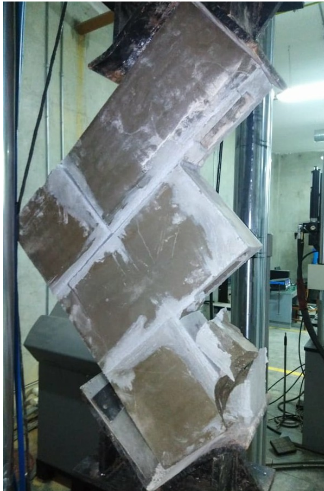
Figura 16: Falla del muro de ladrillos de PET y arena.
