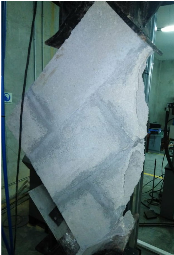
Figura 14: Falla del muro de ladrillos de cemento.
