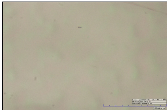
Figura 25. Micrografía óptica de la superficie del aluminio de alta pureza electropulido en una solución 20% ácido perclórico ( \text{HClO}_4 ) y 80% etanol a 7\pm 1^\circ\text{C} por 180 s. 1400X
