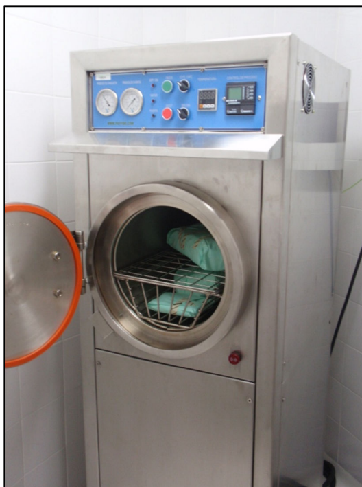
Figura 10. Autoclave PAFFOR modelo PAFF-50-L 1P para la esterilización de muestras rectangulares de aluminio de alta pureza anodizadas en ácido sulfúrico 0.4 M a 5 mA/cm 2 a 5 y 23°C por 600 y 1800 s, sin sellar y el mismo número de probetas selladas a 96°C por 1800 s.
