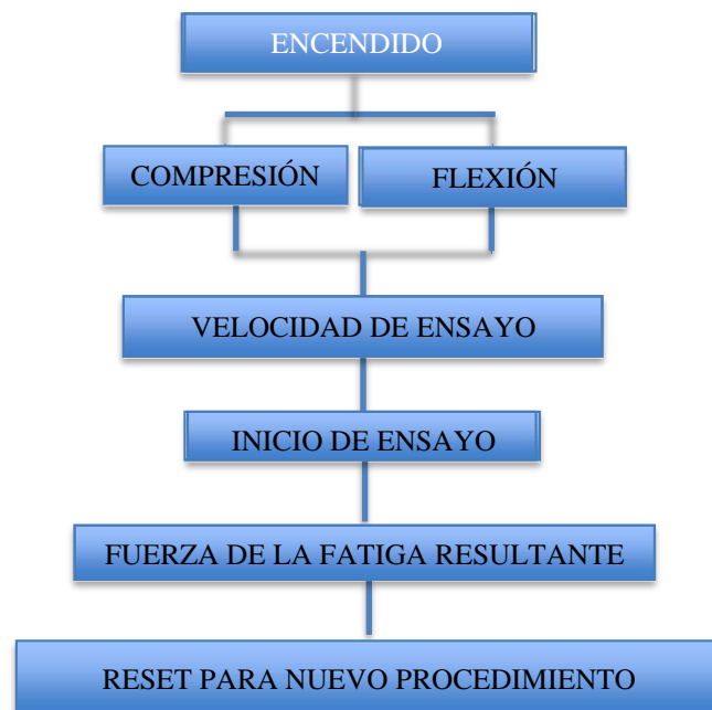
Ilustración 3. Equipo 1: para compresión de concreto un canal
