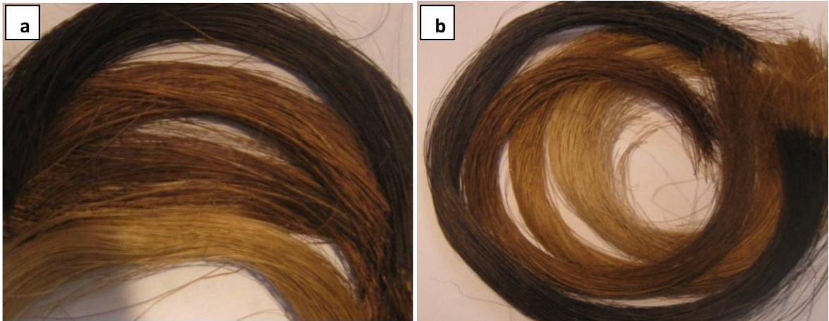
Figura 10. Fibras de fique modificadas con \text{MnO}_2 nanoestructurado, a) síntesis sonoquímica, b) síntesis etanólica. Del color más claro al más oscuro: [\text{KMnO}_4]= 2, 5, 10, 100 \text{ mM} .
