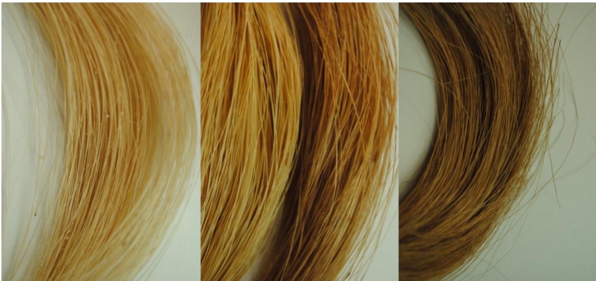
Figura 11. Fibras de fique modificadas con \text{Mn}_3\text{O}_4 nanoestructurado, sintetizado a partir de \text{MnSO}_4 . De izquierda a derecha: [\text{MnSO}_4]=0.5, 5, 10 \text{ y } 100 \text{ mM} .
