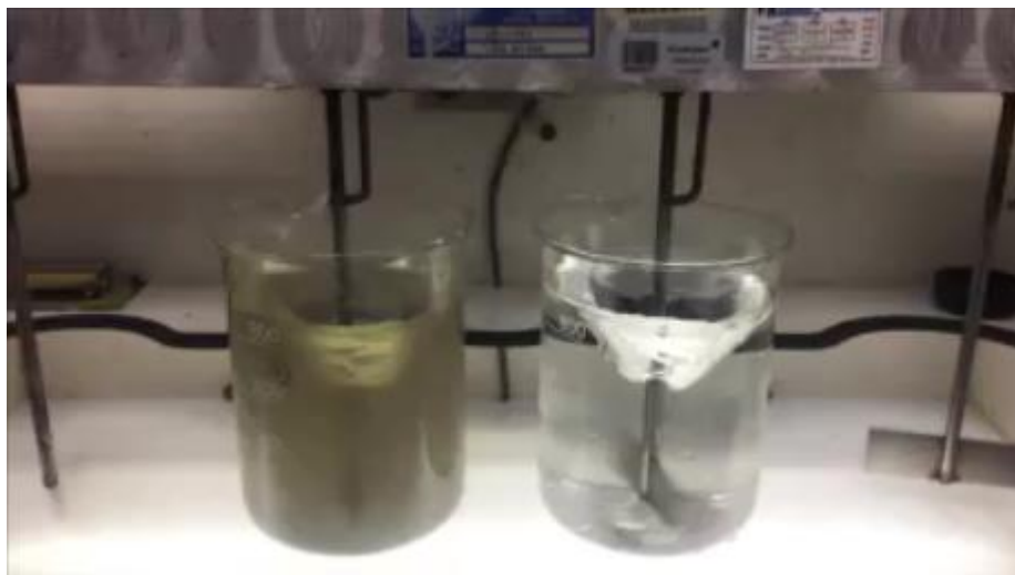
Figura 7. Dispositivo experimental utilizado en los ensayos de oxidación química con peróxido catalizado
