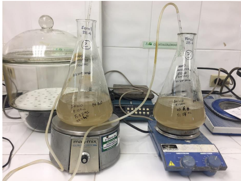
Figura 10. Dispositivo experimental utilizado en los ensayos de biodegradación de fenol con aireación inducida
