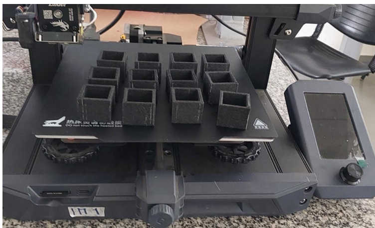
Figura 2. Moldes cúbicos realizados por medio de impresión 3D.
