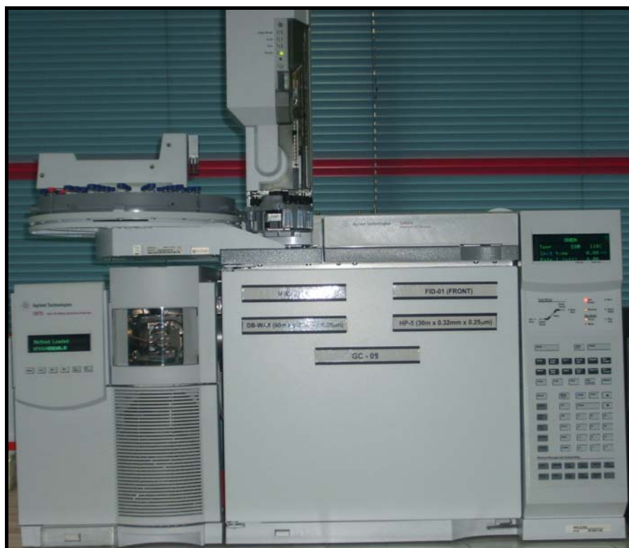
Figura 69. Cromatógrafo Agilent Technologies 6890N Network , acoplado a un MSD Agilent Technologies 5975 Inert XL , y equipado con un inyector automático Hewlett-Packard , modelo 7683 Series Injector .
