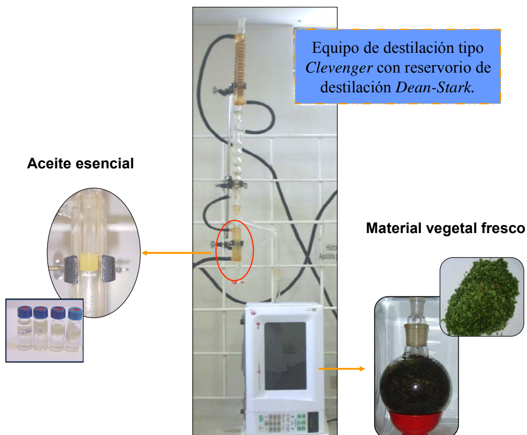
Figura 67. Montaje empleado para obtener los AE por el método de hidrodestilación asistida por la radiación de microondas.
