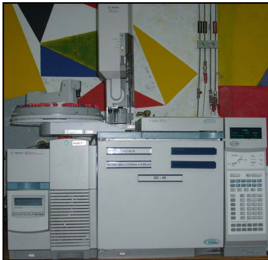
Figura 68. Cromatógrafo Agilent Technologies modelo 6890 Series Plus , acoplado a un MSD Agilent Technologies 5973 Network y equipado con un inyector automático Agilent Technologies , modelo 7863 Series Injector .
