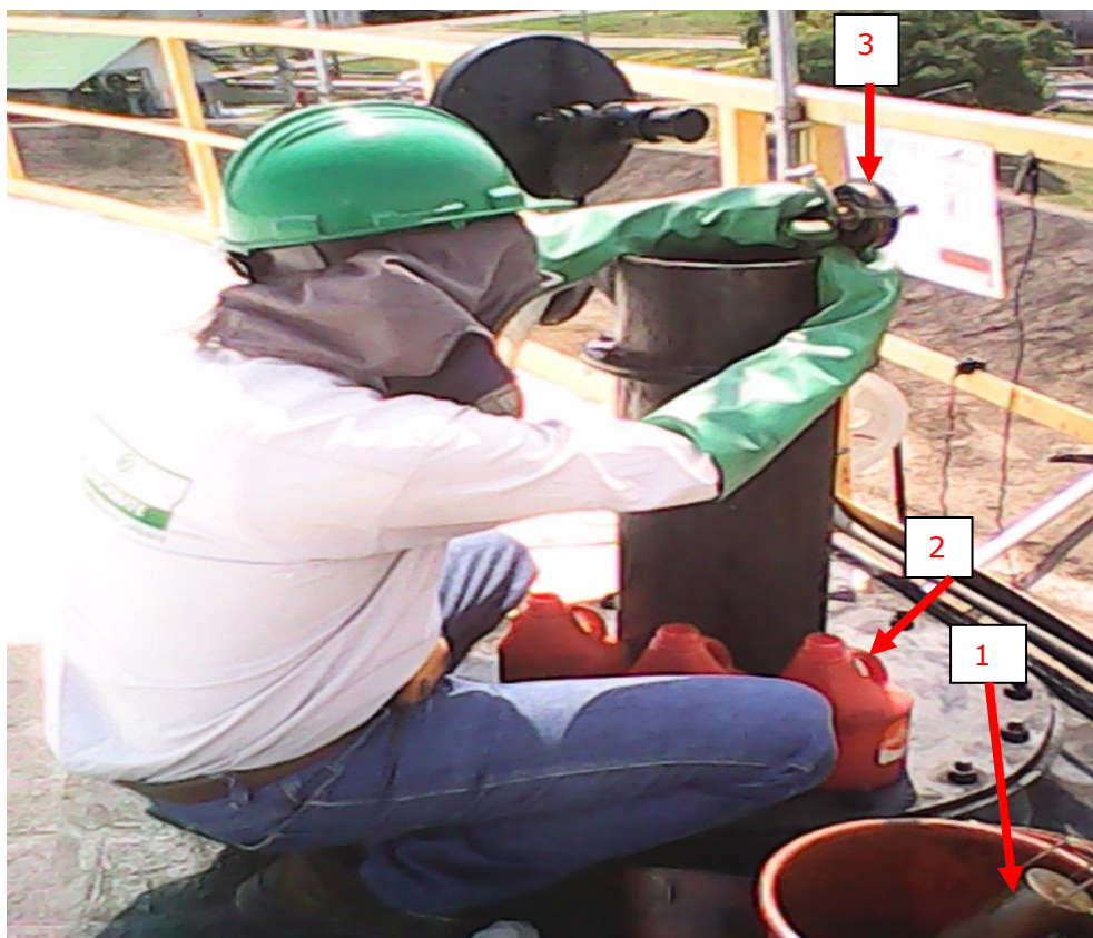
Fig.38 Equipo utilizado y ubicación para toma de muestras y medición de niveles
