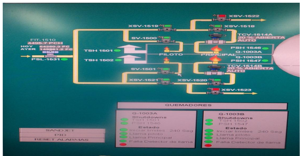
Fig.22 Indicaciones del funcionamiento de los quemadores (aplica para tratadores 3 y 4)
