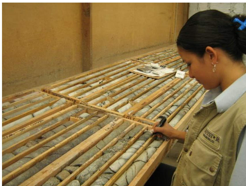
Figura 10. Análisis, descripción e interpretación de las muestras de núcleo de roca.
