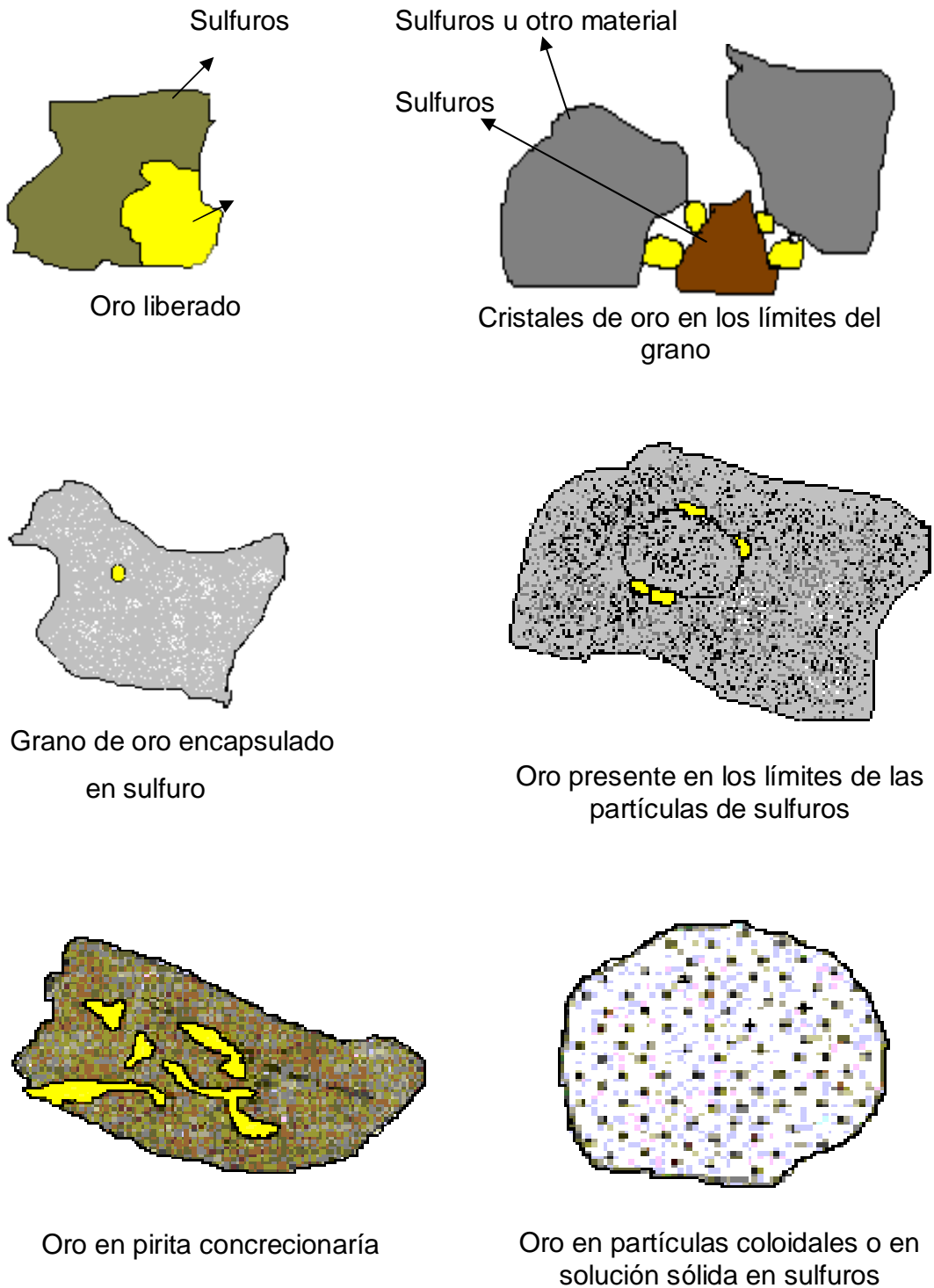
Figura 1. Diferentes tipos de asociación de oro con sulfuros minerales
