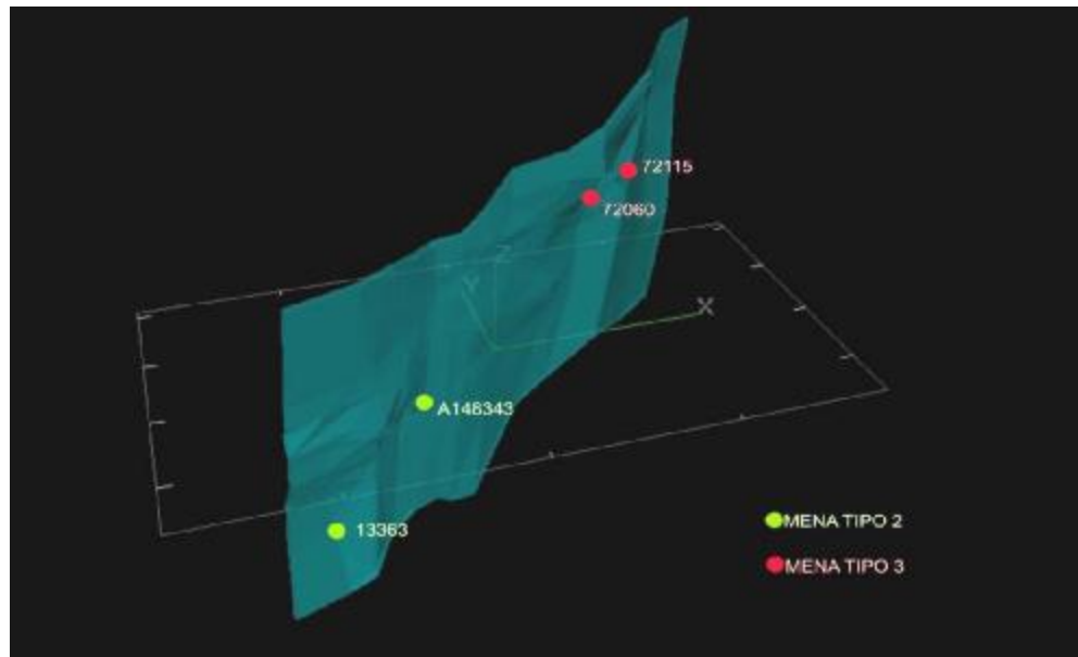
Figura 14. Veta seleccionada con cuatro perforaciones y diferente mineralización.
