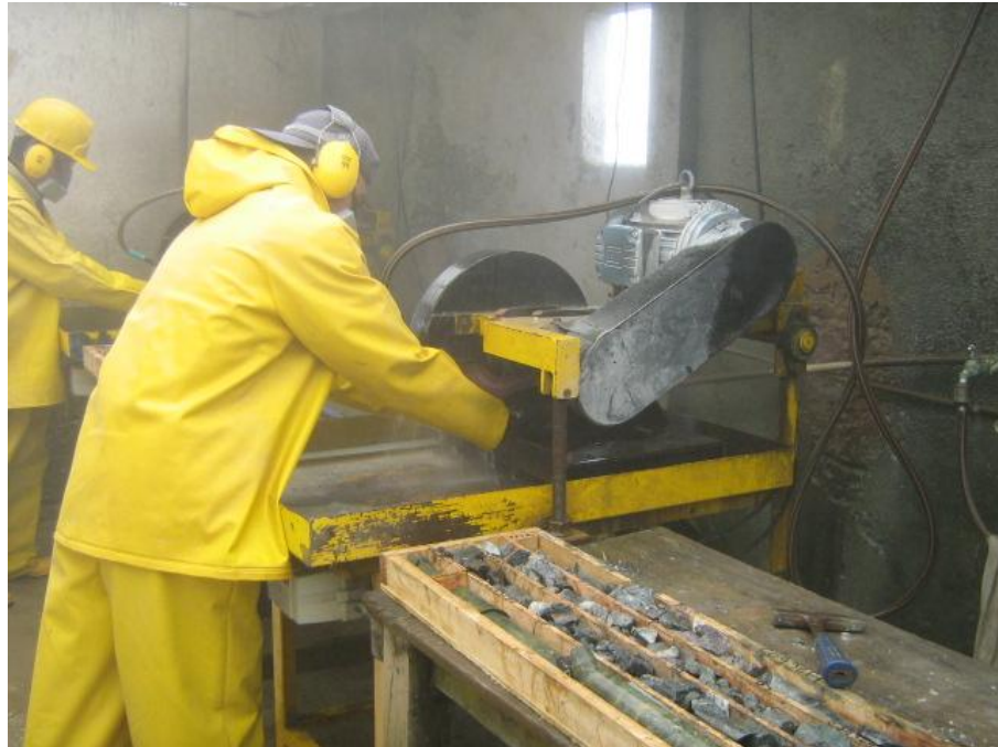
Figura 11. Proceso de corte de las muestras de núcleo.
