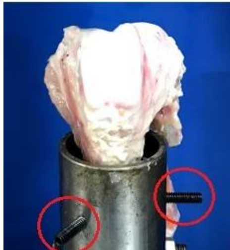
Figura 6. Montaje de Rodilla con Sensor Tekscan(Tekscan Inc., Boston, MA).
