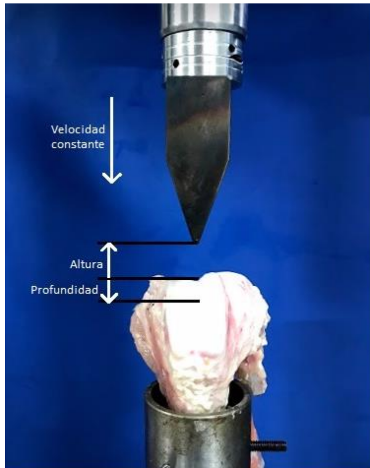
Figura 8. Ensayo de generación de la fractura.
