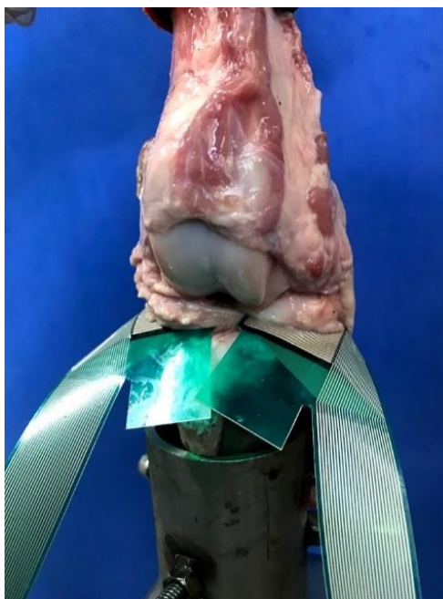
Figura 6. Montaje de Rodilla con Sensor Tekscan(Tekscan Inc., Boston, MA).
