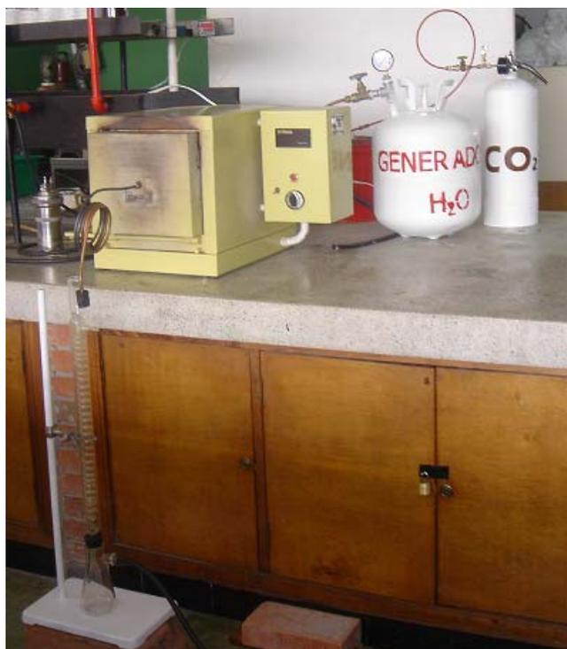
Fig. 7. Montaje de activación con CO<sub>2</sub> o vapor de agua
