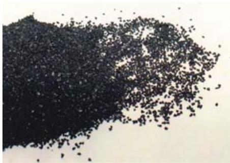
**Fig. 8.** Carbón activado obtenido sin pulverizar
