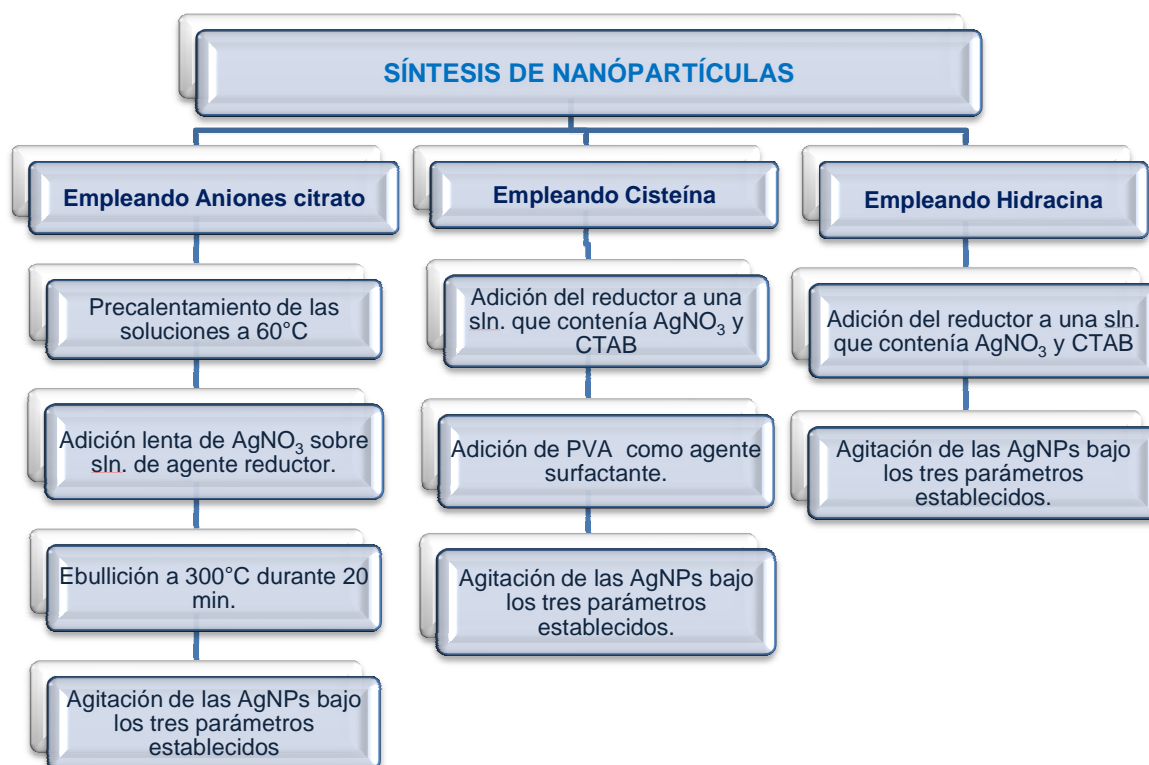
Figura 3 Procedimiento general para la obtención de las AgNPs.
