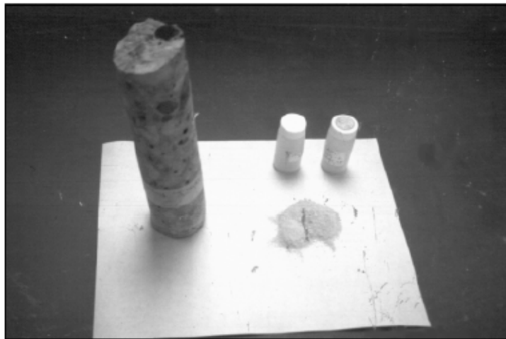
FIGURA 123. EJEMPLO DE EXTRACCION DE MUESTRAS DE POLVO.
