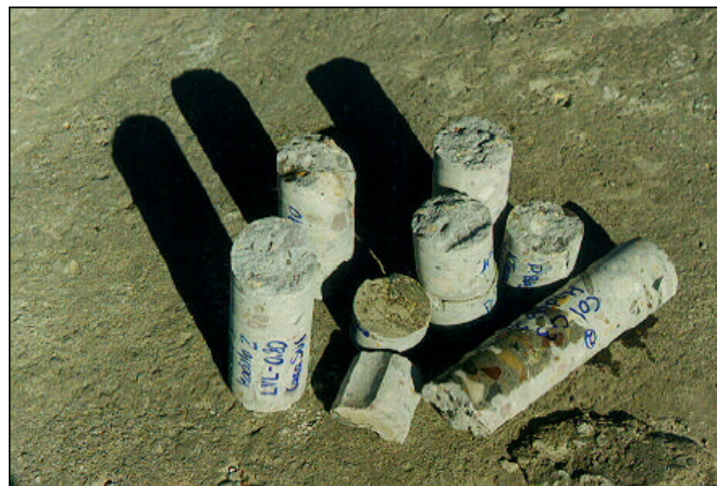
FIGURA 117. EJEMPLOS DE NÚCLEOS DE CONCRETO.
