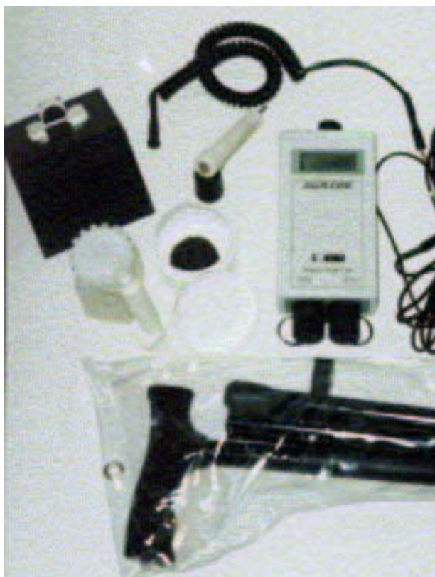
FIGURA 120. EQUIPO DE MEDIA CELDA UTILIZADO PARA MEDIR POTENCIALES ELÉCTRICOS E IDENTIFICAR ZONAS DONDE LA CORROSIÓN ESTÁ PRESENTE.
