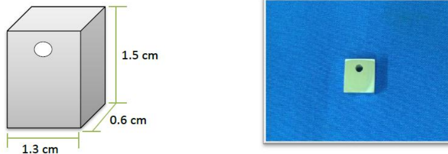
Figura 4. Dimensiones y forma de los cupones empleados para las pruebas gravimétricas o pérdida de masa.
