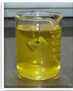
Figura 9. Montaje de la limpieza por decapado químico
