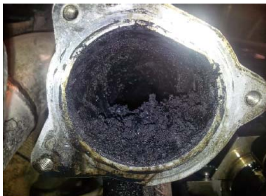
Figura 10. Hollín y lodos en válvula EGR
