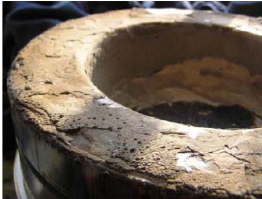
Figura 11. Sedimentos originados por Síloxanos en la corona del pistón
