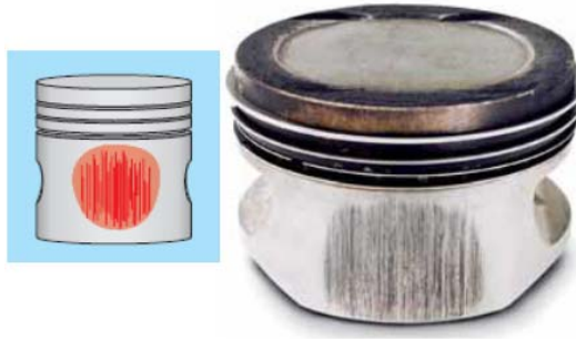
Figura 12. Desgaste por falta de lubricación causada por exceso de carburante
