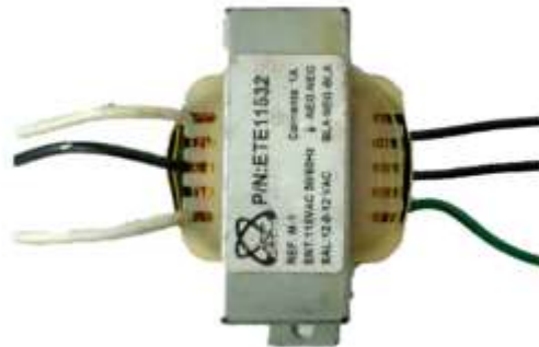
Figura 44. Triac BTA26-6000 para control AC y transformador para fuente de alimentación y detector de cruce por cero
