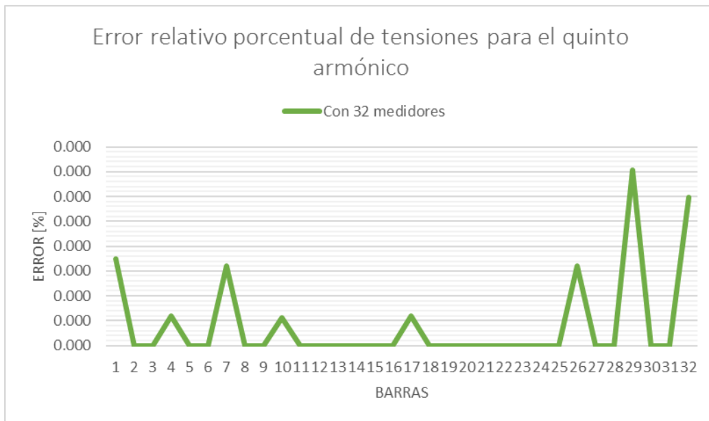
Figura 49 Grafica del error relativo porcentual en las magnitudes de las tensiones estimadas para el quinto orden armónico.
