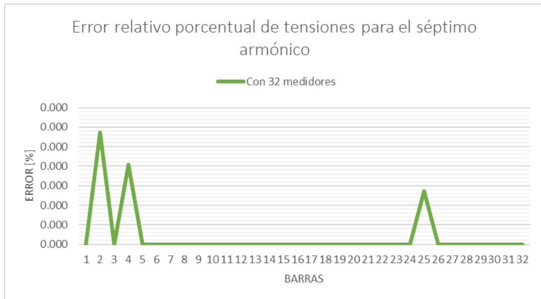
Figura 51 Grafica del error relativo porcentual en las magnitudes de las tensiones estimadas para el séptimo orden armónico.
