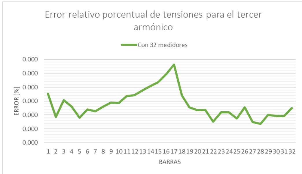
Figura 47 Grafica del error relativo porcentual en las magnitudes de las tensiones estimadas para el tercer orden armónico.
