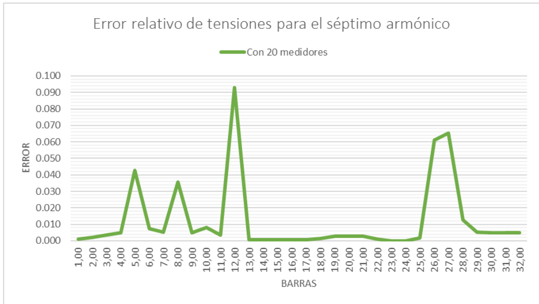
Figura 96 Errores del séptimo armónico para un sistema sub-determinado de 32 barras
