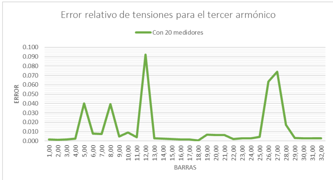
Figura 92 Errores del tercer armónico para un sistema sub-determinado de 32 barras
