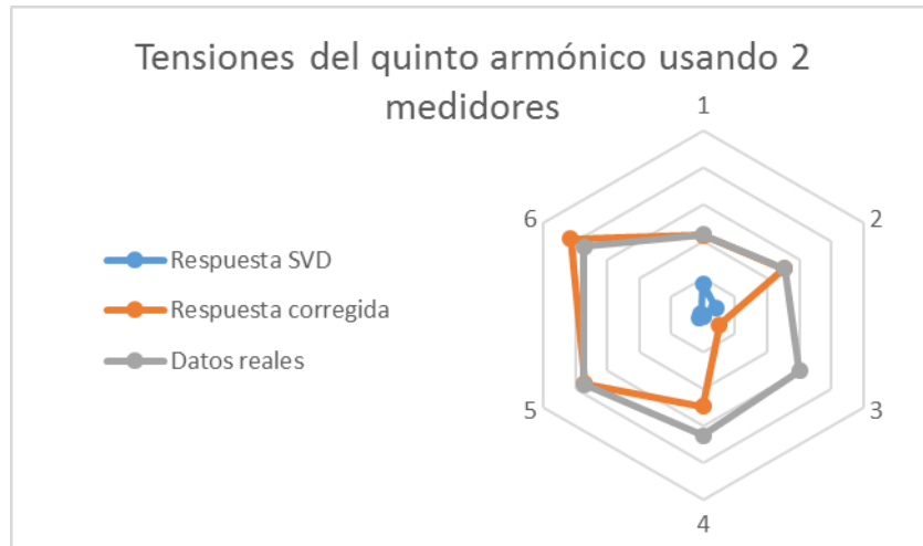
Figura 24 Grafica comparativa de las tensiones estimadas por SVD, los datos corregidos y los datos reales extraídos de ATP para el quinto orden armónico con dos medidores
