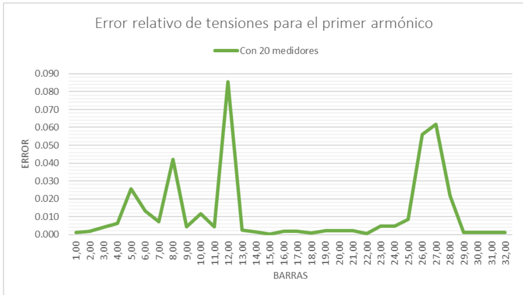
Figura 90 Errores del primer armónico para un sistema sub-determinado de 32 barras
