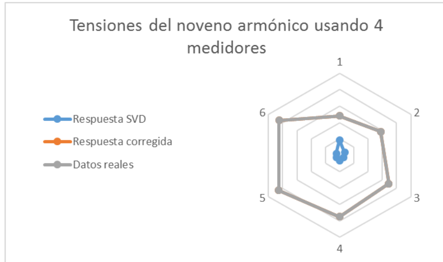
Figura 32 Grafica comparativa de las tensiones estimadas por SVD, los datos corregidos y los datos reales extraídos de ATP para el Noveno orden armónico con cuatro medidores
