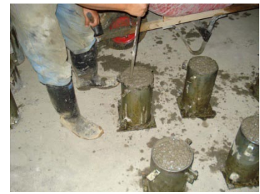
Compactación a la tercera capa
