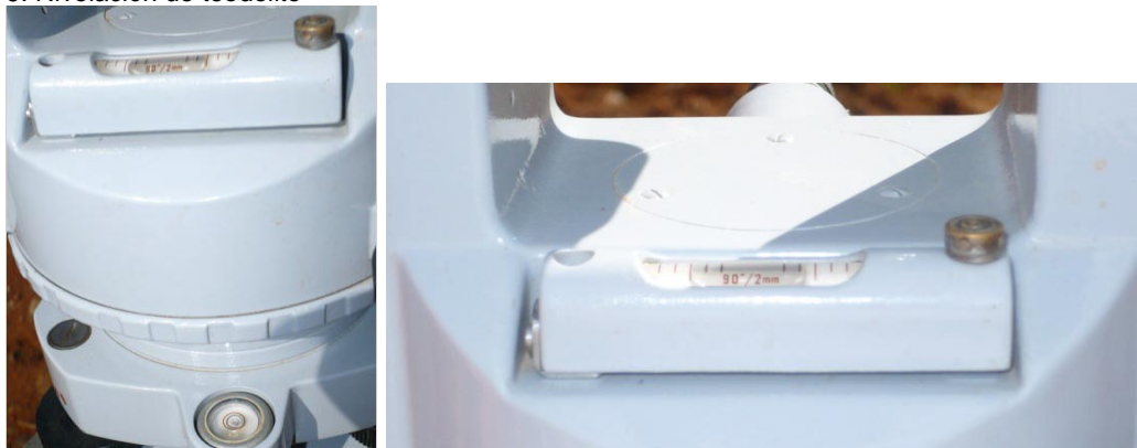
Figura 9. Nivelación de teodolito
