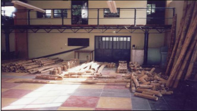
Fotografía 12. Almacenamiento finalizado el proceso de corte y refrentado.
