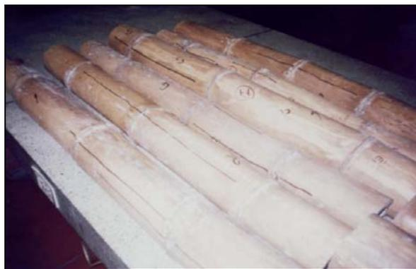
Al igual que en el ensayo de Cortante, después de haber fallado, se procedió a extraer de cada probeta una lámina de aproximadamente 2 cm. \* 4.5 cm. \* 0.5 cm. con el fin de obtener el valor de Densidad Seca al aire, Densidades Anhidra y Contenido de Humedad, estos valores se determinaron para cada probeta en su respectivo formato de Excel; con esto se cumple el tercer objetivo: Determinar las propiedades Físicas y Mecánicas de la Guadua extraída de la zona objeto de estudio.
