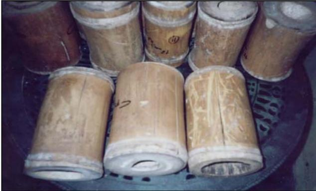
En el Anexo H se presentan los resultados concernientes a los ensayos efectuados bajo esta sollicitación de carga; es relevante mencionar que después de falladas las probetas, a cada una se les tomó una lámina de aproximadamente 2 cm \* 4.5 cm \* 0.5 cm; con el fin de obtener el valor de Densidad Seca al aire, Densidades Anhidra y Contenido de Humedad, estos valores se determinaron para cada probeta en su respectivo formato de Excel.
