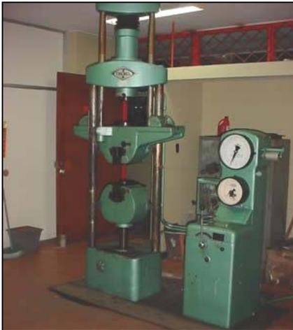
Se realizaron los ensayos para determinar el Módulo de Elasticidad, utilizando la escala de 0 – 20 toneladas, con una aproximación en las lecturas de 500 Kgf para las probetas de Basa y la escala de 0 - 40 toneladas, con una aproximación de 1.000 Kgf para las probetas de Cepa.
