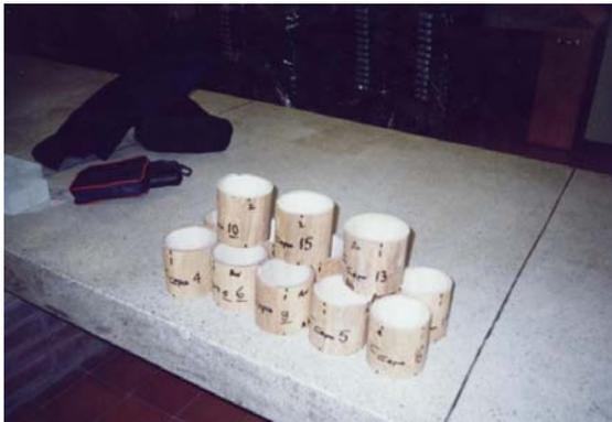
PROCESO DE MEDICION: Previo a este proceso , se hicieron una serie de marcas con el fin de agilizar la toma de lecturas para establecer los valores promedio de Altura, Diámetro Interno, Diámetro Externo y Espesor de la pared de cada una de los ejemplares y se realizó de la siguiente manera:
