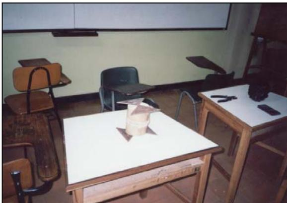
**3.6.11 DETERMINACIÓN DEL MODELO DE ENSAYO.** Para determinar Esfuerzo Máximo a Cortante Paralela a la fibra de la Guadua, se siguió el procedimiento del “Laboratory Manual on Testing Methods for Determination of Physical and Mechanical Properties of Bamboo” establecido por la norma INBAR (Anexo A). Las probetas se ensayaron en la Máquina Universal de Ensayos - Marca TREBEL (Ver Fotografía No. 55).
