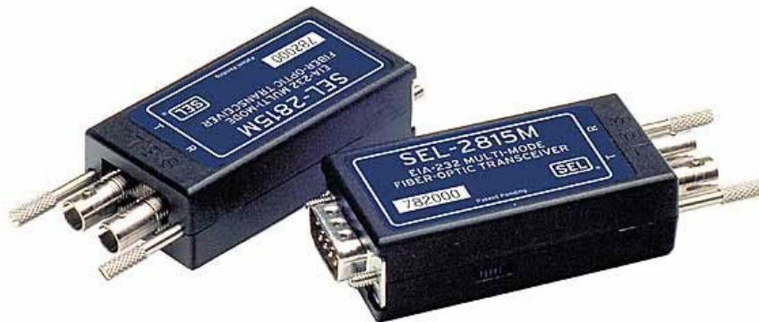
Figura 1.10. Transceiver 2815. Comunicación de hasta 15 Km.
