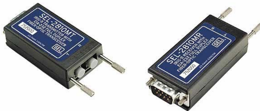
Figura 1.3. Transceiver 2810. Para comunicación serial full-duplex. Fuente: Manual SEL 200.
