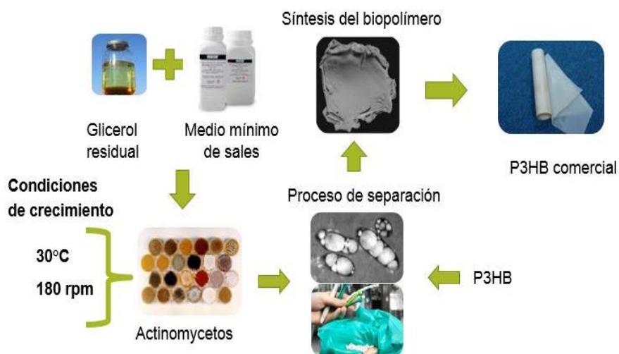
Figura 1. Esquema del proceso de producción del P3HB
