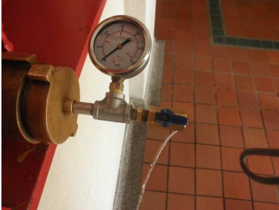
Potencia insuficiente en la bomba contra incendio
