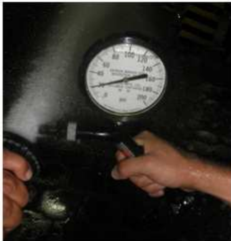
medicion de presion con tubo de pitot
