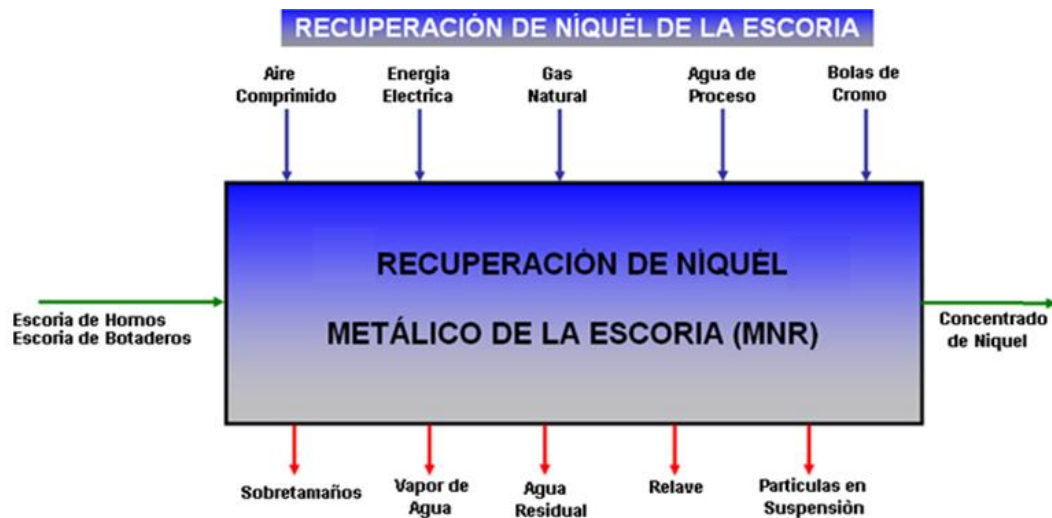
Figura 1. Diagrama de corrientes de entrada y salida del proceso de MNR
