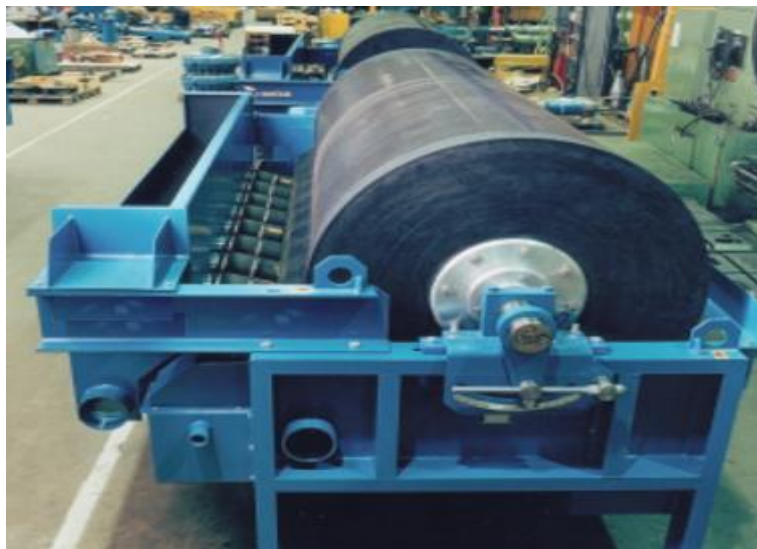
Figura 6. Separador Magnético para proceso en húmedo
