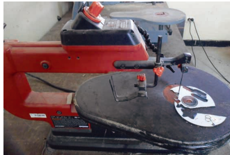
Figura 11. Corte CD en caladora de banco.
