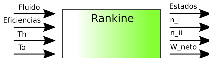
Figura 14. Función de el modelo del ciclo Rankine.
