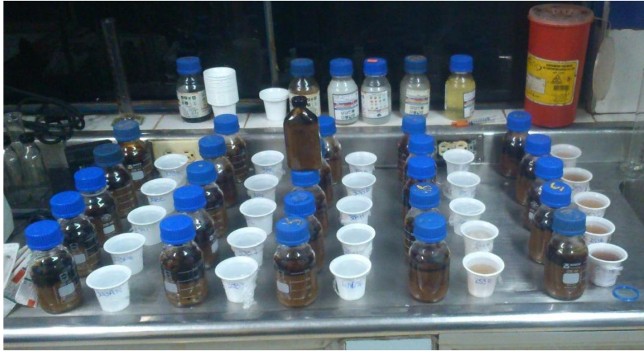
Figura 8. Montaje de las pruebas de botellas realizadas con los 25 rompedores inversos
