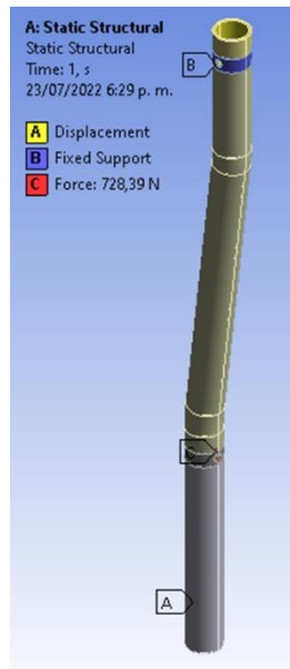
Figura 42. Condiciones de contorno del tubo lateral inferior
