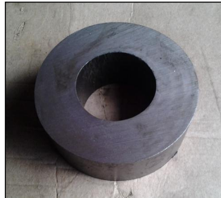
Ilustración 118. Disco Perforado. Acero SAE AISI 1020.
