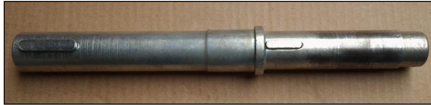
Ilustración 113. Eje 1. Acero SAE AISI 1045.
