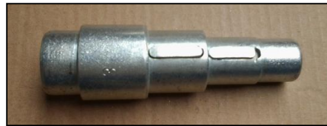
Ilustración 115. Eje 3. Acero Aleado SAE AISI 4140.
