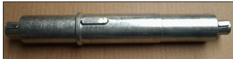
Ilustración 116. Eje 4. Acero Aleado SAE AISI 4140.
