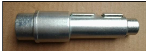
Ilustración 114. Eje 2. Acero al Carbono SAE AISI 1045.
