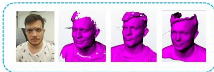
Figura 34. Proceso de toma de datos de un usuario en orden desde la izq. Toma de datos: con calibrador, Go! Scan, Sens y Kinect. Adaptado de Calderon, Camargo, y Lopez (2017).
