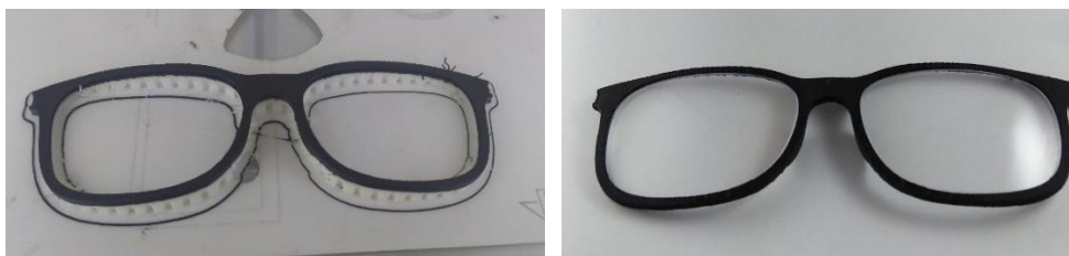
Figura 24. Primera impresión y montaje de lentes, frente de las gafas.
