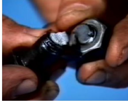
Figura 11. Rotura en un perno a tensión
