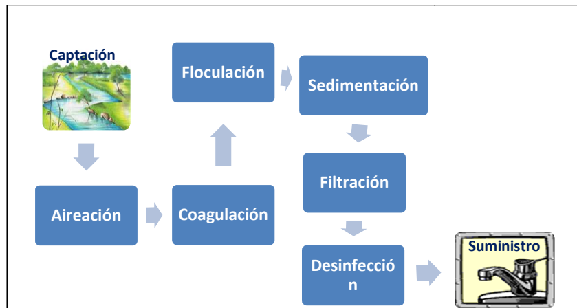
Figura 5. Etapas del proceso de potabilización del agua.
